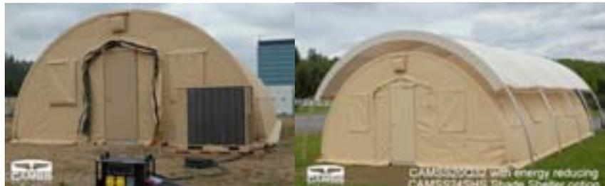
*Camss20Q. Con accesorios generadores + renovación de aire con recuperación de energía.*
