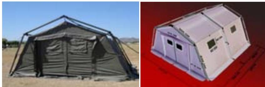
*Tienda HV de estructura rígida exterior. Aseguran un tiempo máximo de montaje de menor de 5 minutos. Esta estructura tiene una resistencia a vientos de 85km/h durante 30min con rachas superiores a los 100km/h. Nieve admisible en techo de 50kgs/m<sup>2</sup>*
